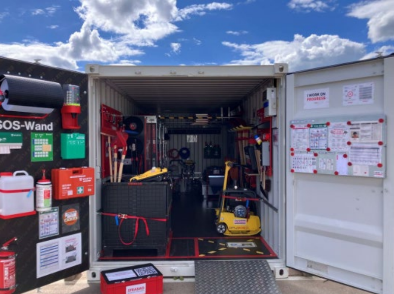
Fot. Przykład zastosowania 5S w praktyce - kontener budowlany zaadaptowany na standaryzowany magazyn sprzętu.
